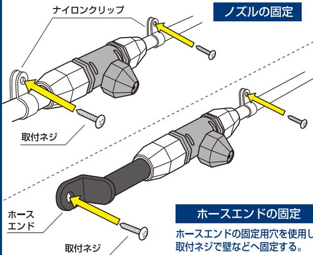
**3** ホースをナイロンクリップで固定後、ノズルを回転させてミストの出る位置を調整してください。
